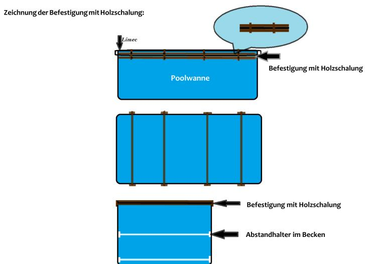
Die Schalung dient zur Befestigung des Pools, damit dieser beim Betonieren der Wand nicht verformt wird! Die Poolwand muss im unteren und mittleren Bereich ausgespreizt werden, um Verformungen durch den Druck der Betonmischung zu vermeiden.
